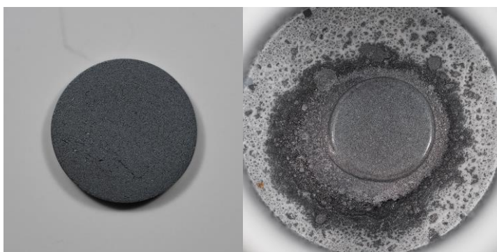
図2 1250°Cで3時間保持した窒化ホウ素坩堝内へマタイトロッド(直径10mm)の変化。左が過熱前、右が加熱後
